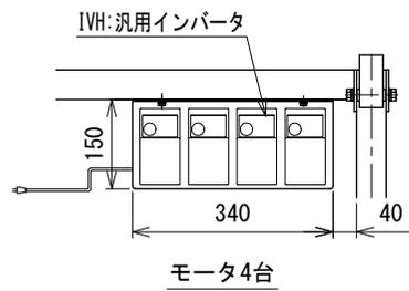
注1 本図は呼び幅 400 mm、呼び機長 200 cm、切離しタイプ(モータ4台)
