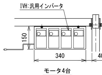
注1 本図は呼び幅 500 mm、呼び機長 200 cm、切離しタイプ(モーター4台)
