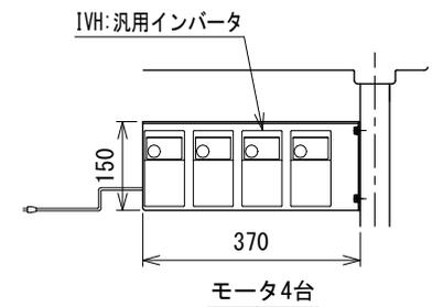
注1 本図は呼び幅600 mm、呼び機長 2000 mm、切離しタイプ(モータ4台)
